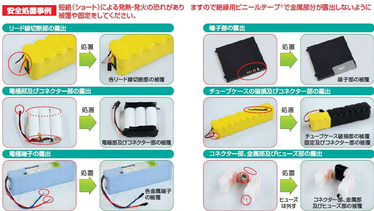
図 廃リチウムイオン電池の安全処置方法（事例） 出典）一般社団法人 JBRC
