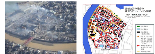
【令和6年能登半島地震で発生した大規模市街地火災(左)と放任火災とした場合の火災延焼シミュレーション結果(右)】
