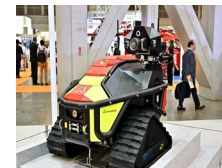
【無人走行放水ロボット】
